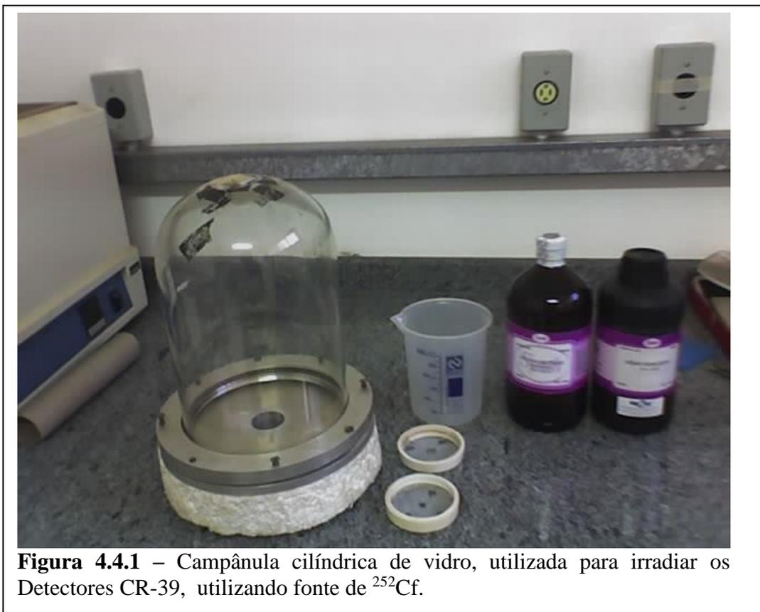
A fonte sintética utilizada foi de  $^{252}\text{Cf}$ , colocada no buraco central da montagem mostrada na figura acima, os detectores eram grudados às paredes da campânula de vidro, em sua região lateral. Não foram colocados detectores na parte central, pois o intuito do experimento era apenas didático, para que fosse possível fazer os ataques químicos e as observações ao microscópio (contagem dos traços), por isso foram desconsiderados os efeitos da depleção dos traços.
